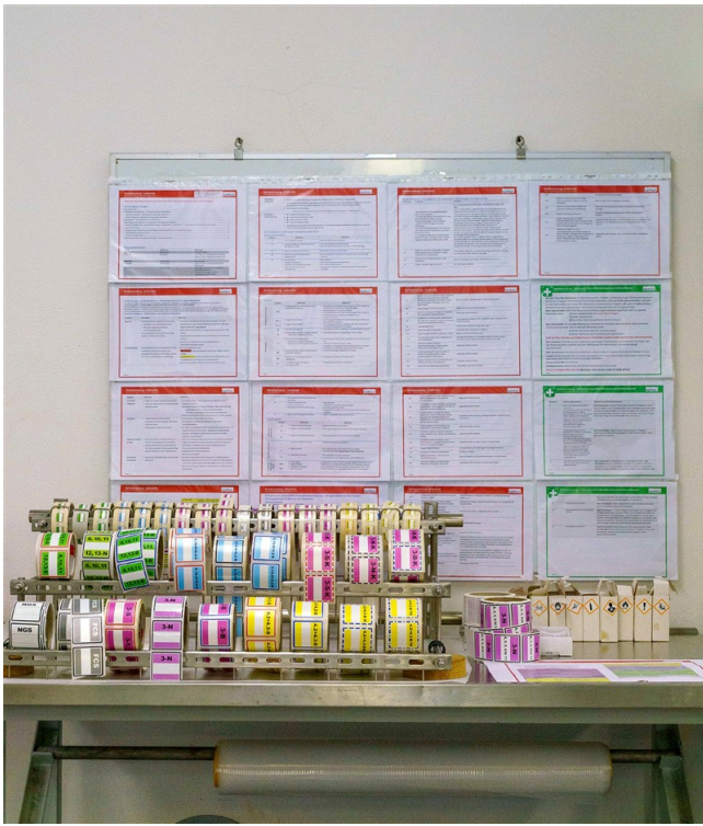
Aushang BA Gefahrstoffe mit Labelstation
