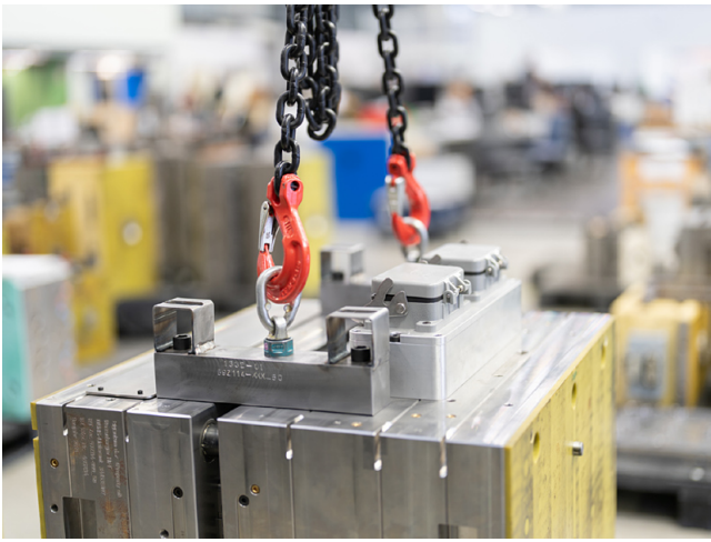
Bild 1: Spritzgusswerkzeug mit Werkzeugbrücke am Kran
