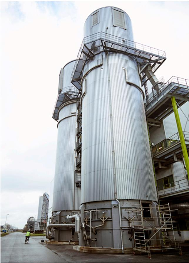
Bis zu 20 Meter hoch sind die Extraktionstürme, in denen aus den Zuckerrüben der Rohsaft gewonnen wird.
