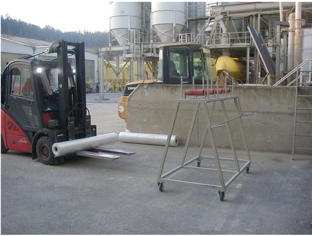
Folienrolle wird mit einem Gabelstapler auf die Einrichtung gehoben
