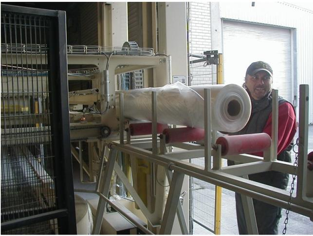
Arretierung nach unten geklappt und Folienrolle in den Plattenwickler geschoben
