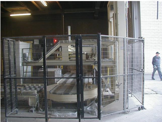
Zielposition Folienrolle: Hubrahmen für die Montage in die untere Stellung verfahren
