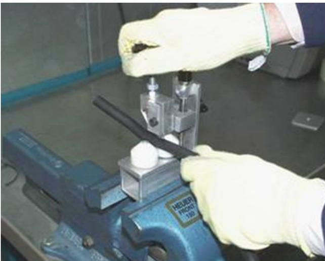
Schnittverletzungen durch Abrutschen beim Aufschneiden der Schläuche praktisch ausgeschlossen
