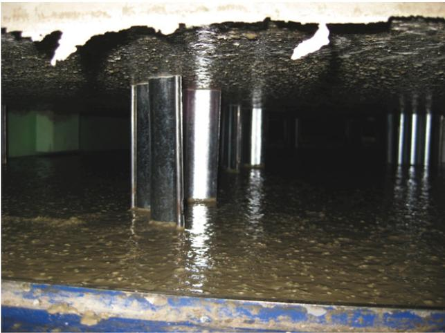
Die erste Schale wurde in die frische zweite Schale eingewendet.
