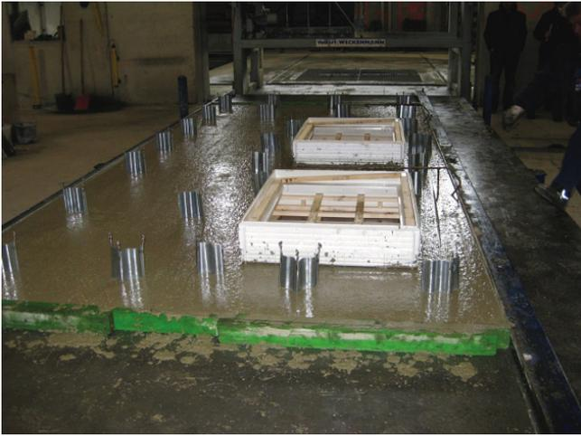
Erste Schale der Doppelwand mit KAP-Stahl-Wellen.
