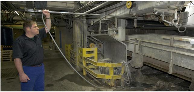
Der Mitarbeiter kommt nicht mit den Reinigungsmitteln und den sich drehenden Walzen in Berührung er kann die Verunreinigungen von außen entfernen.
