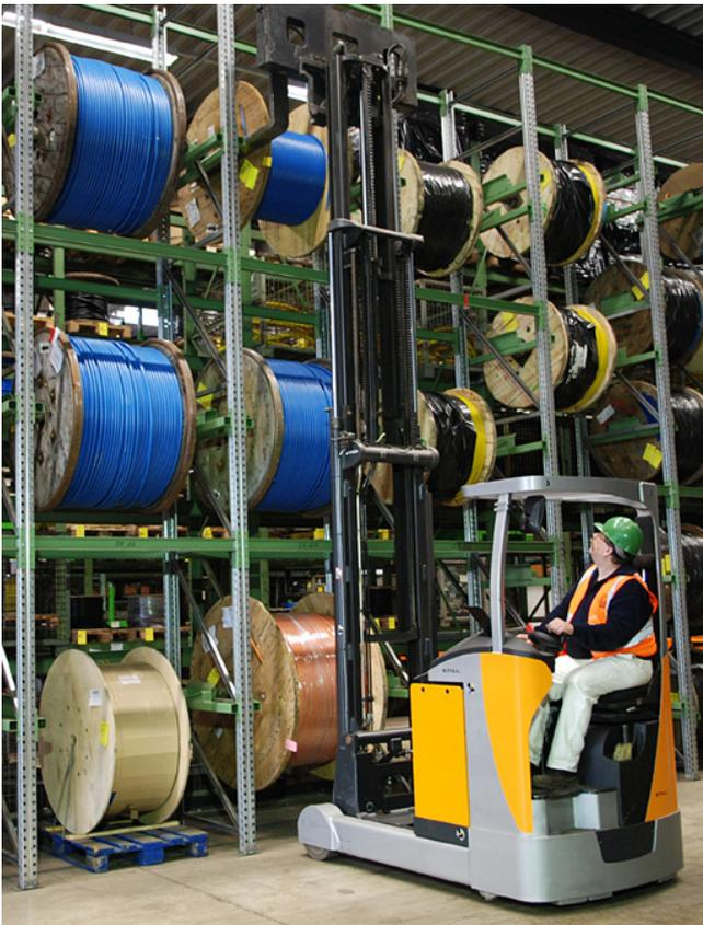
Kabeltrommeln im Hochregal: Das konventionelle Einlagern und Entnehmen kann mit Gefährdungen, wie etwa dem Absturz der Trommel, verbunden sein.
