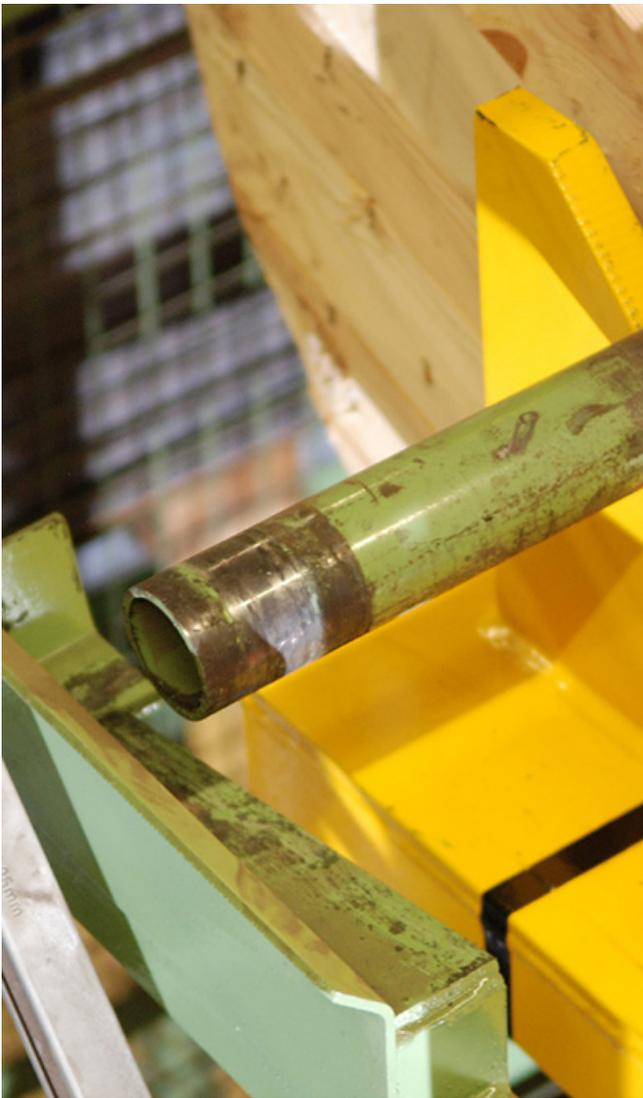
Auch die Trommel-Aufnahme für das Hochregal wurde verbessert: Die Auflagefläche wurde vergrößert und als Schräge ausgeführt, die abgelegte Trommel rollt darüber in die definierte Arretierungsposition.
