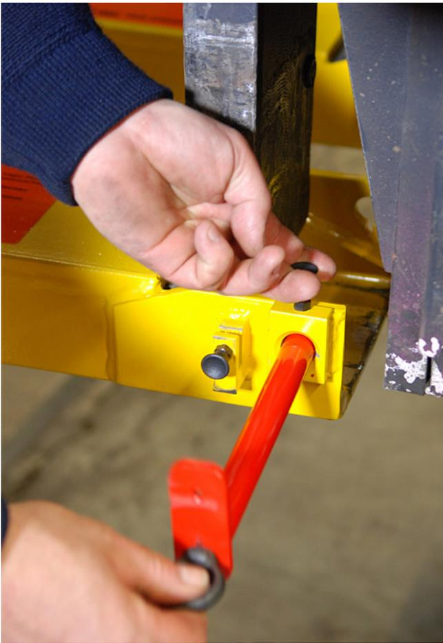
... die einfach auf die Zinken des Gabelstaplers aufgesetzt und formschlüssig arretiert wird.
