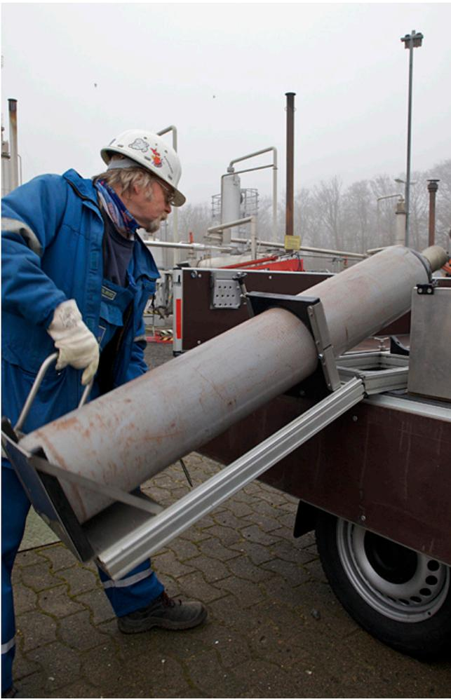
Mit der Halte-, Verlade- und Transportvorrichtung der Wintershall-Mitarbeiter können auch ältere Mitarbeiter die bis zu 80 Kilo schweren Gasflaschen gefahrlos und rückschonend verladen.
