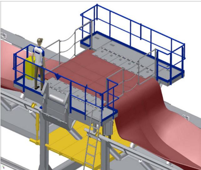
Der schematische Aufbau der RWE-Power-Reparaturplattform für die Beseitigung von Bandschäden. Gut zu erkennen sind die sicheren Standflächen für die Arbeiten am Ober- sowie am Untergurt.
