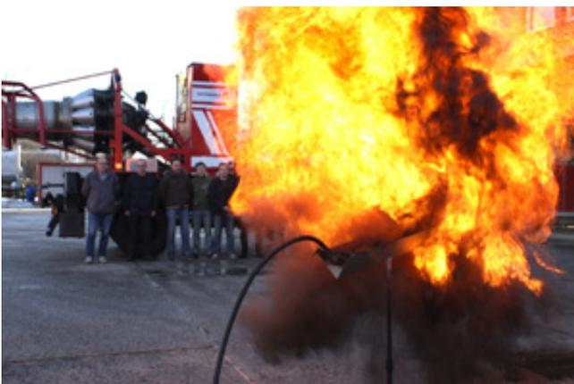
Lothar Hopka und Ulrich Wegner von der Vattenfall Europe Mining AG vom Tagebau Welzow-Süd haben einen Explosionssimulator für brennbare Stäube entwickelt. Durch die gezielt eingeleitete Staubexplosion erleben die Mitarbeiter die Notwendigkeit konsequenter Staubbekämpfung. Für diese Idee zu einer überzeugenden Vermittlung
