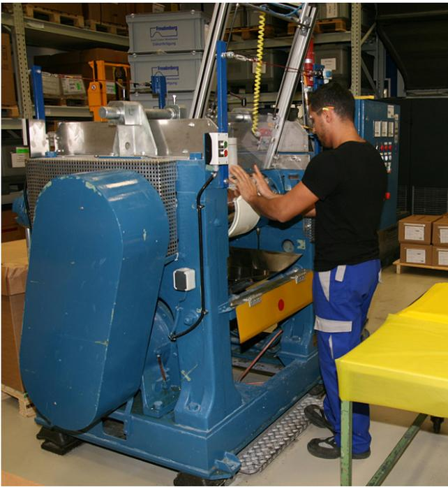
Die neu entwickelte Sicherheitseinrichtung verhindert wirksam das Erreichen der Einzugsstelle bei laufender Maschine. Foto: bgrci/Plöger
